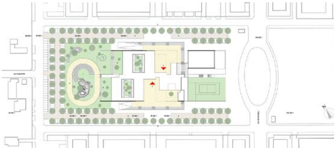
**Figura 9. Planimetria generale di progetto, all'interno delle previsioni del Piano di Zona. E' possibile notare come il progetto utilizzi il verde come recinzione naturale in cui inserire i percorsi pedonali interni ed esterni di relazione con il quartiere. L'ingresso è segnato dall'isola ellissoidica che divide i flussi di traffico su sensi di marcia opposti e delimita l'area di accesso alla scuola.**
